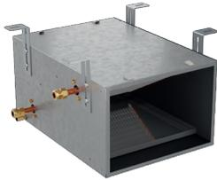
Batteria idronica di post-trattamento ad acqua calda e/o fredda. Completa di coibentazione interna fonoassorbente in poliuretano a cellule aperte e vaschetta di raccolta della condensa. Utilizzabile per portare l'aria di immissione alla temperatura desiderata. Componibile con coperchi serie AIR400. Collegabile ai plenum COMPACT serie AIR400 tramite kit di raccordo serie AIR490. Installazione a parete o soffitto.
